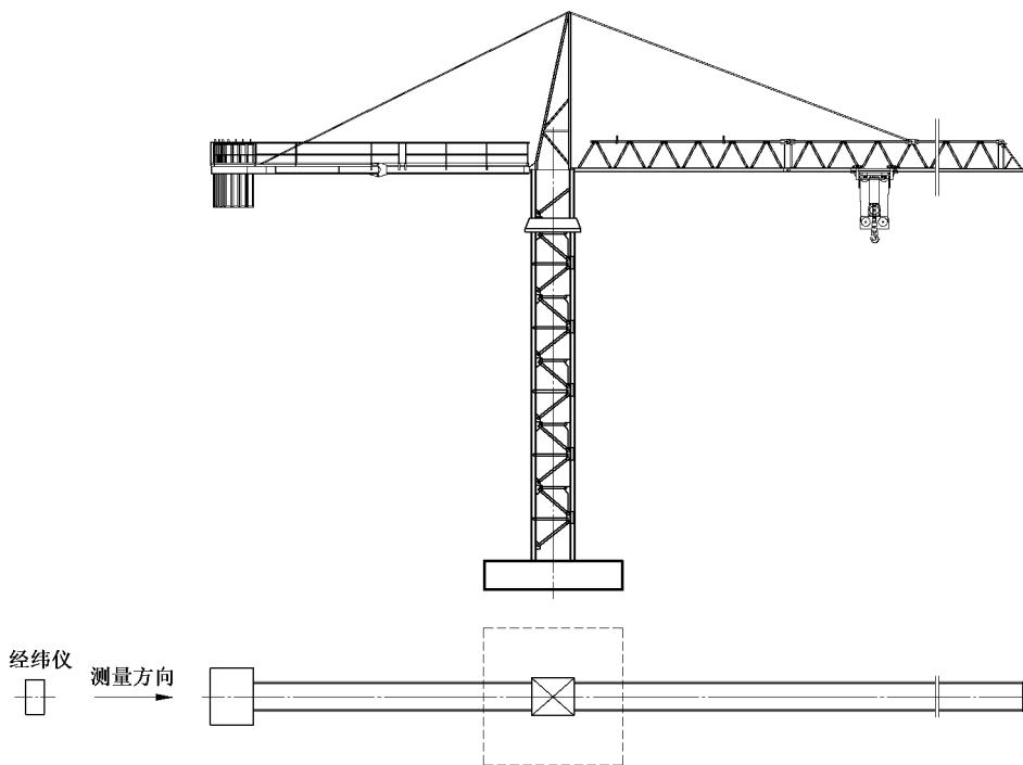
图 6 侧向垂直度测量方向示意图
